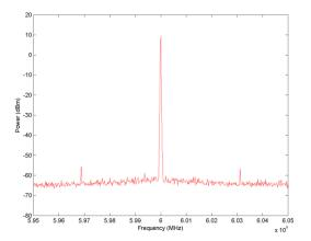
Figure 9a: 6GHz Narrow Band Spectrum
