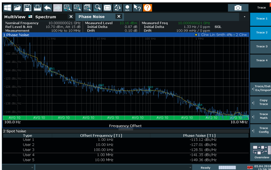
Фазовый шум при отстройке 10 кГц от несущей 10 ГГц; тип. –133 дБн (1 Гц)
