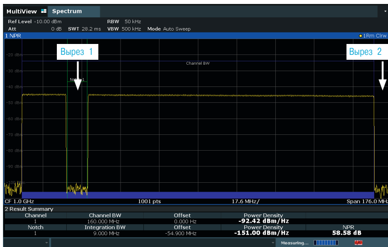
Измерение коэффициента мощности шума с помощью опции R&S®FSW-K19
