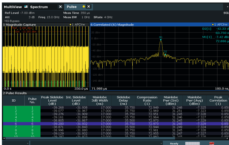
Показаны параметры сжатия импульсов и отображение коррелированной величины ЛЧМ-импульса с помощью опции R&S®FSW-K6S.
